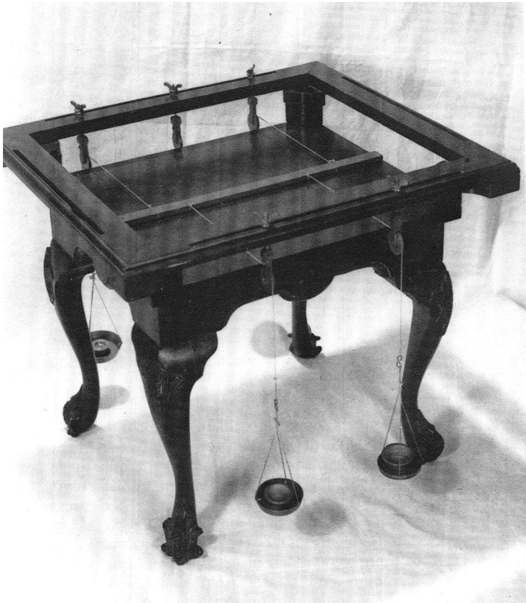
Fig. 2 : Equilibre des forces parallèles, d'après 's Gravesande. Rijksmuseum voor de geschiedenis der natuurwetenschappen. Leyde.
