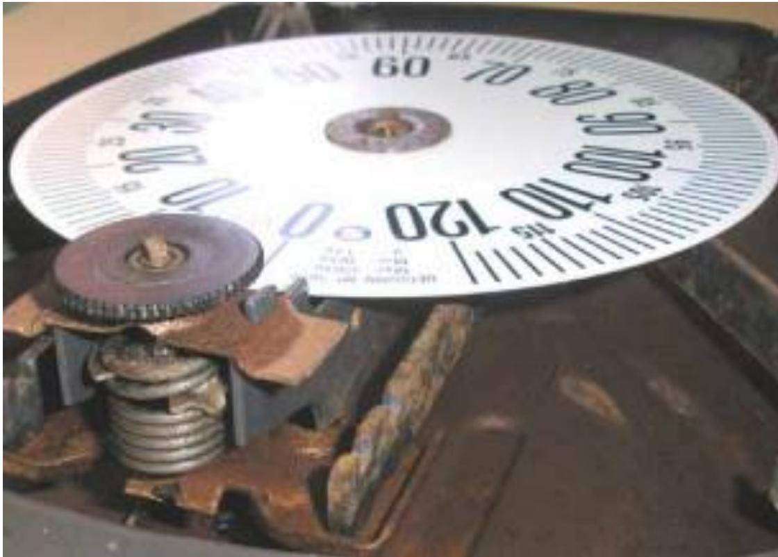
C'est un piège, c'est le poids de la personne donc une force qui écrase le ressort comme avec un dynamomètre. Mais grâce à  $P = m \times g$  il est gradué en masses.
